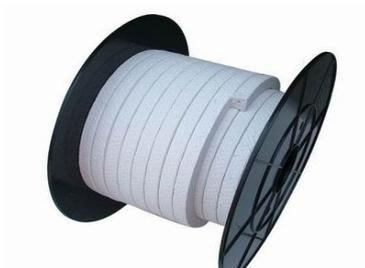
苧麻盤根是采用高质量苧麻纤维方形编织而成. 在编织过程中经过特殊的四氟乳液及阻隔剂. 在四氟乳液阻隔剂的作用下. 苧麻盤根的截面更加致密. 强度更高. 摩擦系数更低. 对泵轴及阀杆不会造成磨损. 少维修. 易安装.
